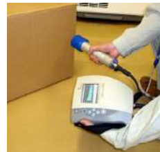
現場での貨物放射能分析（La-Br可搬型スペクトロメータ）
