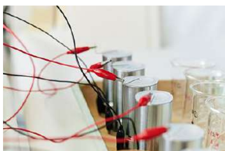
\alpha 核種分析用 電着試料作製
