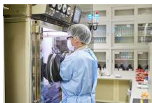
無菌アイソレータ内薬剤分注装置作業
